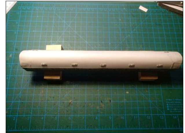
D13. Αεραγωγοί οροφής κόλληση στο μοντέλο D13. Roof air vents gluing into model
