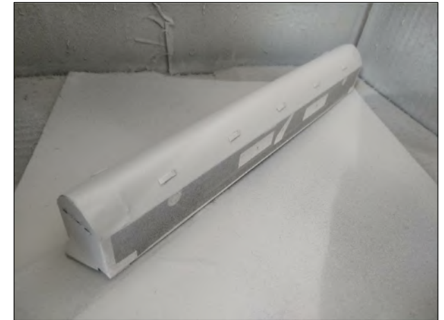
D16. Βαφή οροφής Ψεκασμός με σπρέι/αερογραφο D16. Roof painting Spraying with color spray / airbrush
