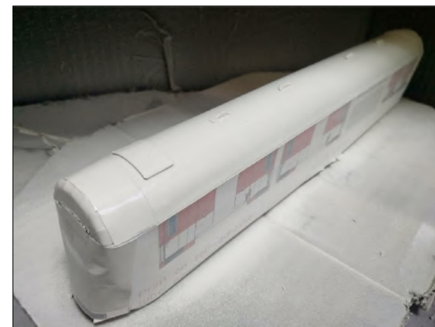
D16. Βαφή οροφής Ψεκασμός με σπρέι/αερογραφο D16. Roof painting Spraying with color spray / airbrush
