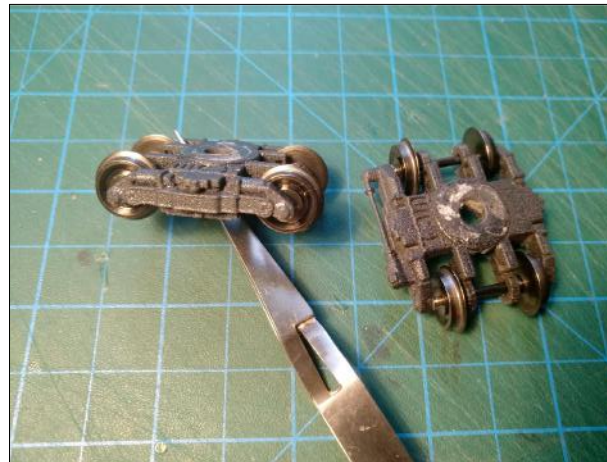
F6. Φορεία Τοποθέτηση των αξόνων στα φορεία (όψη 1) F6. Bogies Assembly of axles into the bogies (view 1)
