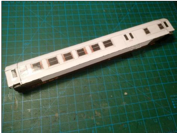
D1/D2. Κόλληση εσωτερικών λωρίδων παραθύρων και διαφανής κολλητικής ταινίας. Οψη διαμερισμάτων D1/D2. Internal windows band sticking and adhesive tape placing. Compartments view
