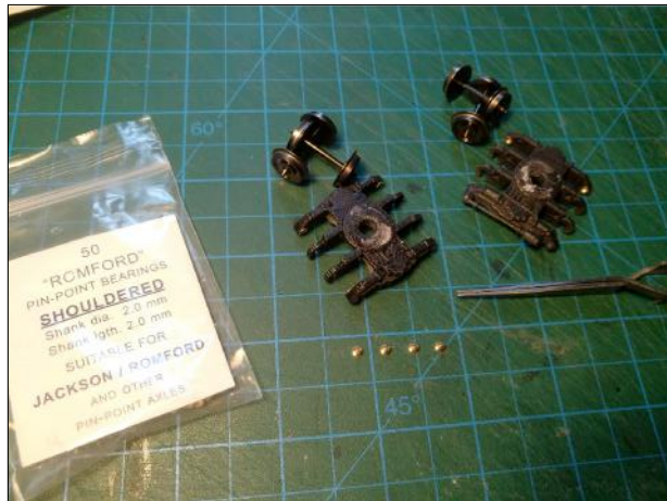
F6. Φορεία προετοιμασία, βαφή και τοποθέτηση κουζινεττων F6. Bogies preparation, painting and bearings assembly
