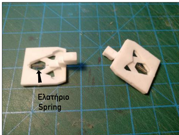
F5. Μηχανισμός close coupling συναρμολόγηση (Εναλλακτικά δυνατή χρήση μηχανισμού "RibukKD" ή "Symoba 101+103") F5. Close coupling mechanism assembling (Alternatively, "RibukKD" or "Symoba 101+103" mechanisms can be used)
