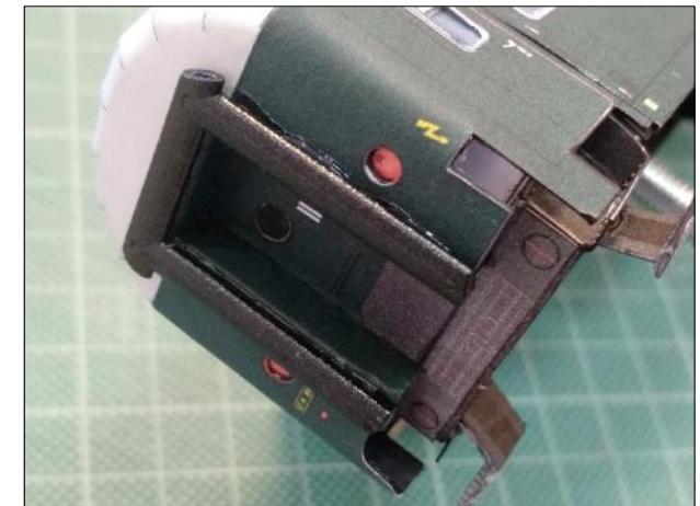
F2. Μετωπικές φυσούνες επικοινωνίας τοποθέτηση και κόλληση (όψη 1) F2. Frontal connection gangways fitting and gluing (view 1)
