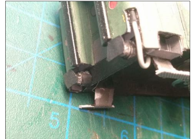
F4. Ταμπόνια κόλληση στο βαγόνι (όψη 1) F4. Buffers gluing into wagon (view 1)
