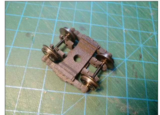
F6. Φορεία Τοποθέτηση των αξόνων στα φορεία (όψη 2) F6. Bogies Assembly of axles into the bogies (view 2)
