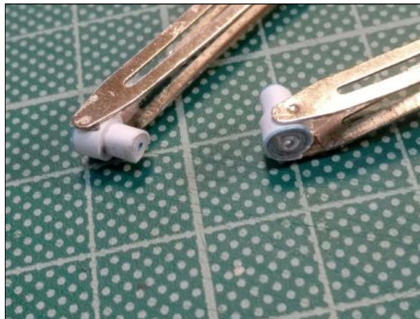
F4. Ταμπόνια τύλιγμα και κόλληση τεμαχίων F4b επί των F4a F4. Buffers rolling and gluing of pieces F4b into F4a
