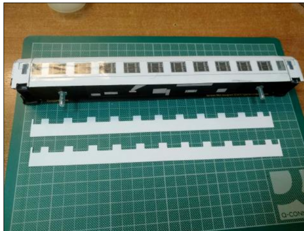
D4. Εξωτερικά κομμάτια παρειών - κοπή D4. External side pieces - cutting
