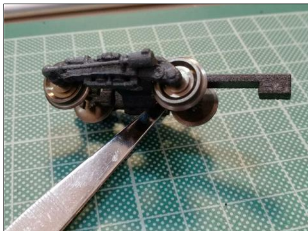
F6. Φορεία - Εναλλακτική B' - Φορεία συμβατικού coupling ΠΡΟΣΟΧΗ ! Επιλέγοντας συμβατικό coupling μην ακολουθήσετε το βήμα F5 ! F6. Bogies - Alternative B' - Conventional coupling bogies ATTENTION ! When using conventional coupling, do not follow step F5 !
