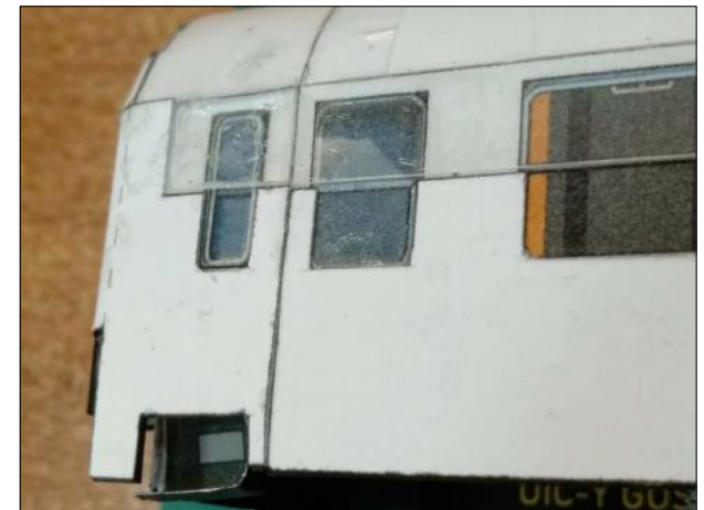
D6. Τεμάχια διάφανου πλαστικού - κόλληση στο σώμα του βαγονιού (όψη 1) D6. Transparent plastic pieces - gluing into wagon body (view 1)
