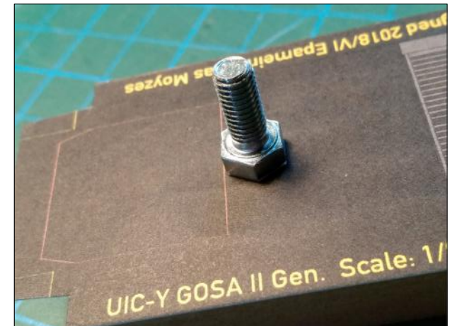
Λεπτομέρεια συναρμογής. Κόλληση με εποξική κόλλα Assembly detail. Gluing with epoxy glue
