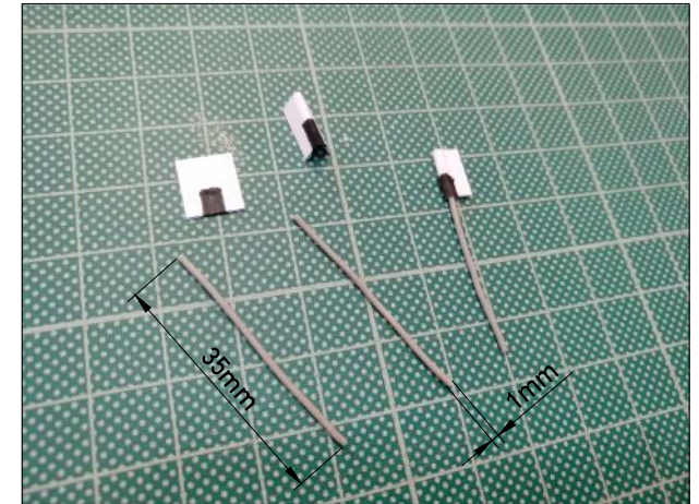
F3. Μετωπικά καλώδια κοπή , τσάκιση και κόλληση στο καλώδιο F3. Frontal cables cutting, folding and fitting into cable
