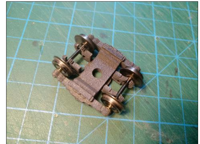
F6. Φορεία Τοποθέτηση των αξόνων στα φορεία (όψη 2) F6. Bogies Assembly of axles into the bogies (view 2)
