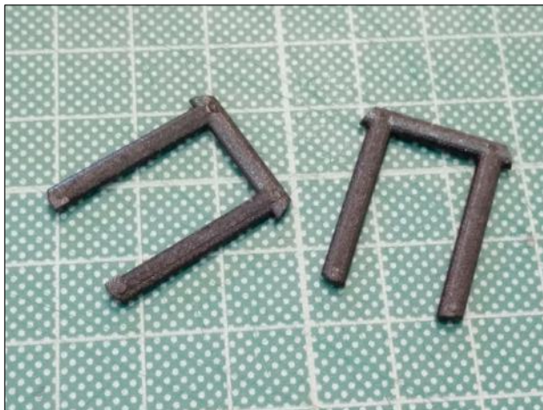
F2. Μετωπικές φυσούνες επικοινωνίας - Εναλλακτική Α' : αντικείμενο απο 3D εκτύπωση προετοιμασία και βαφή F2. Frontal connection gangways - Alternative A' 3D printed part preparation and painting
