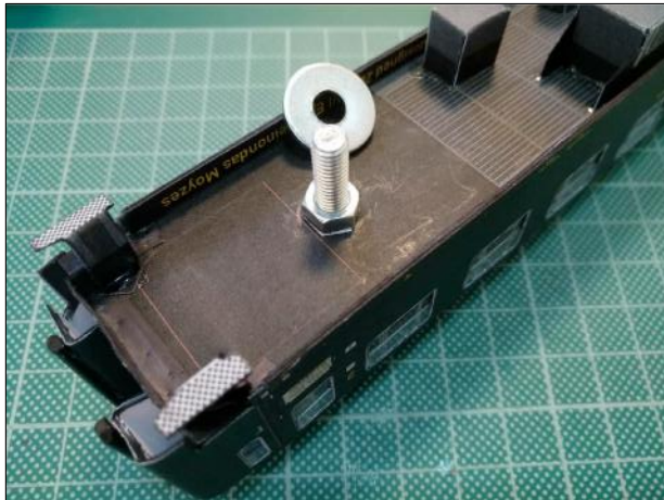
F1. Ολοκλήρωση ομφαλού φορείου - ροδέλλα M5 F1. Bogie bolster finishing - Washer M5
