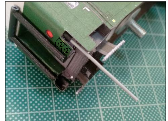
F3. Μετωπικά καλώδια - τοποθετηση, βημα A κόλληση (όψη 3) F3. Frontal cables - fitting, step A Gluing (view 3)
