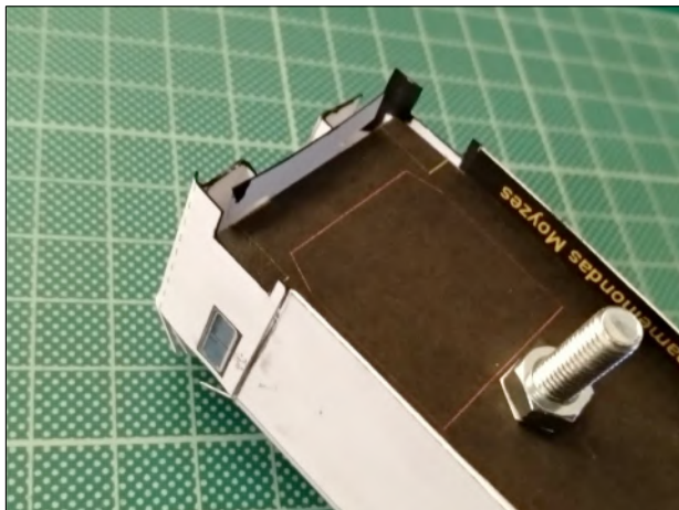
C4. Συναρμολόγηση εσωτερικού κομματιού μετώπης στο σώμα του βαγονιού. Οψη 4 C4. Assembly of internal wagon-end piece into wagon body. View 4
