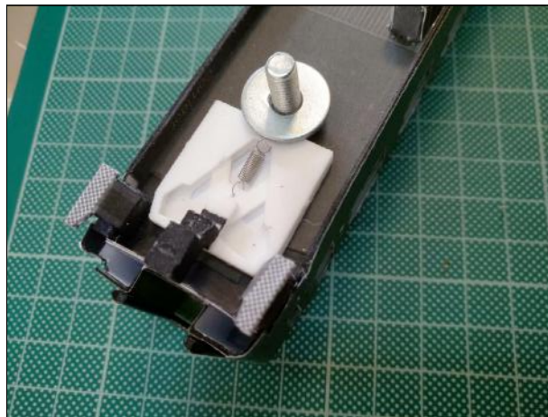
F5. Μηχανισμός close coupling τοποθέτηση και κόλληση (όψη 1) F5. Close coupling mechanism fitting and gluing (view 1)
