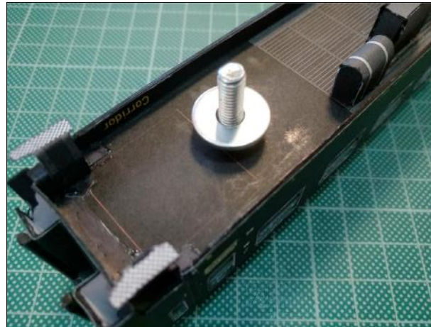
F1. Ολοκλήρωση ομφαλού φορείου - ροδέλλα M5 κόλληση με κυανοακρυλική κόλλα F1. Bogie bolster finishing - Washer M5 Gluing using cyanoacrylate glue
